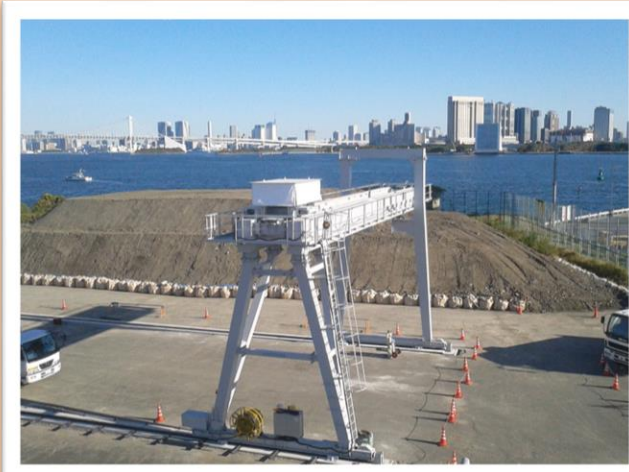
30t橋形クレーン-クラブ式SP17m+3m
