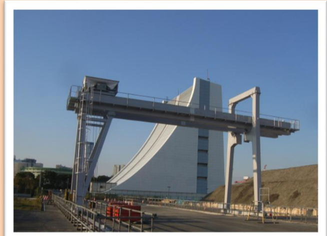
30t橋形クレーン-クラブ式SP17m+3m
